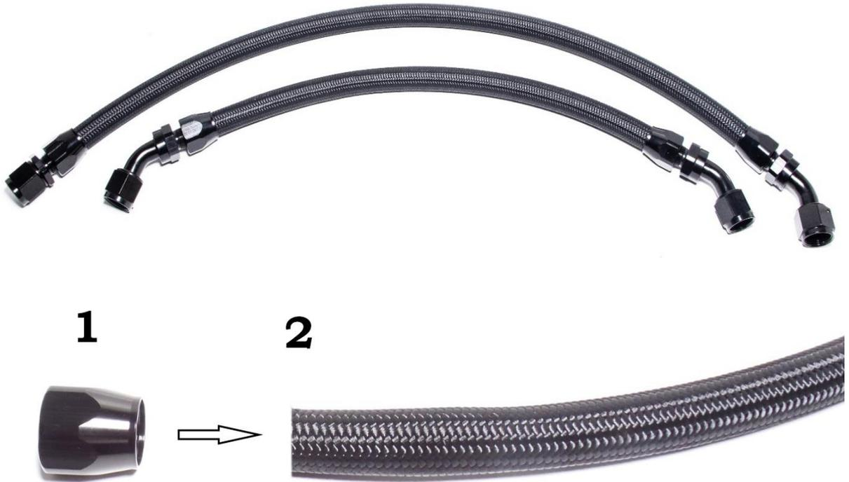
Um die Schläuche zu verschrauben, nimmst Du die Überwurfmutter (1) ab und drehst diese links herum auf den Schlauch (2). Damit schneidet sich automatisch ein Gewinde in den Schlauch.
